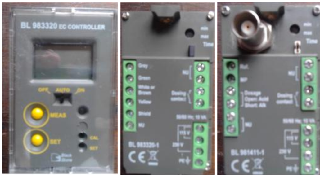
Vista frontal controlador Vista trasera controlador conductividad y pH.
